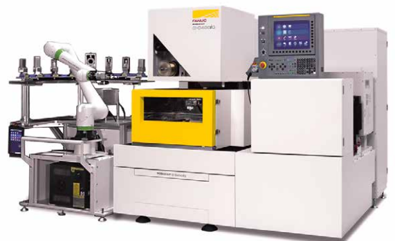
采用了机器人的工件装卸单元例
