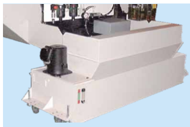
切削液装置(水槽部分)
