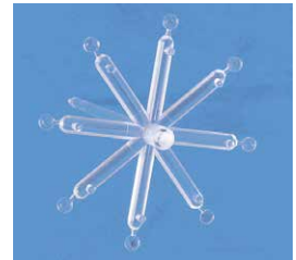
智能手机用摄像镜片 材料：COC
