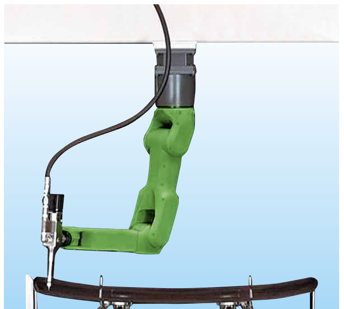
对汽车前窗玻璃进行涂胶（顶吊安装）
