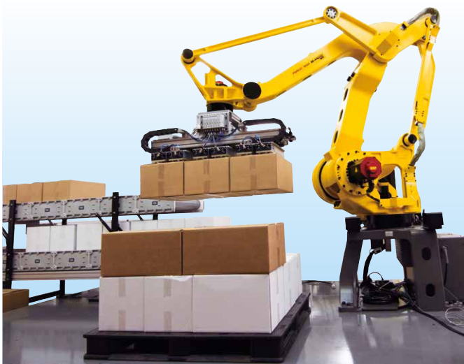
瓦楞纸箱的码垛堆积系统
