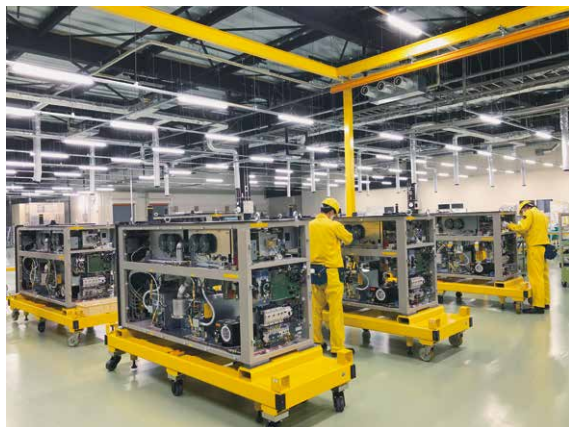
CO 2 レーザの組立 二氧化碳激光发生器的组装
