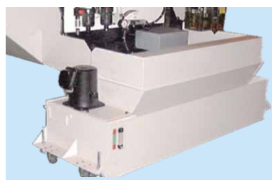
クーラント装置 (タンク部)
