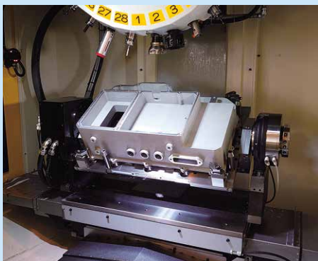
DDR-TiBを使用した割出部品加工
