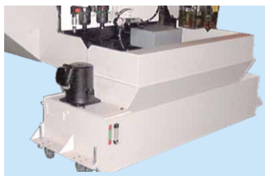
クーラント装置 (タンク部)
