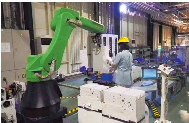
作業者と協働ロボットによるユニット組立 Assembly of a unit by a worker and collaborative robot
