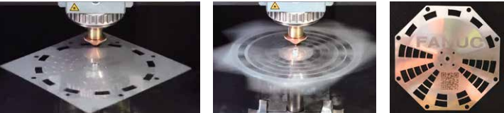
高速、高精度的旋转工件切割加工和打标加工 “FANUC”文字标
