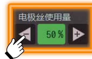
从开粗到精修, 加工精度不变, 电极丝消耗量最多可节省50% 可调节范围: 50% -100%
