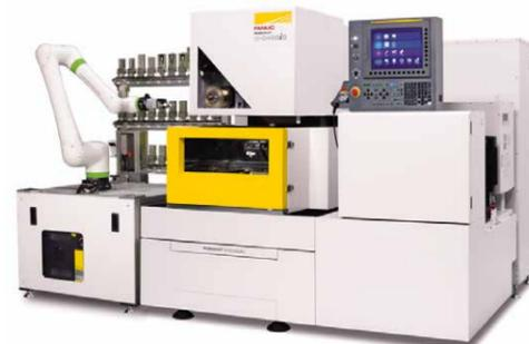
采用了机器人的工件装卸单元例
