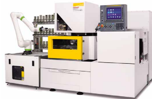
采用了机器人的工件装卸单元例
