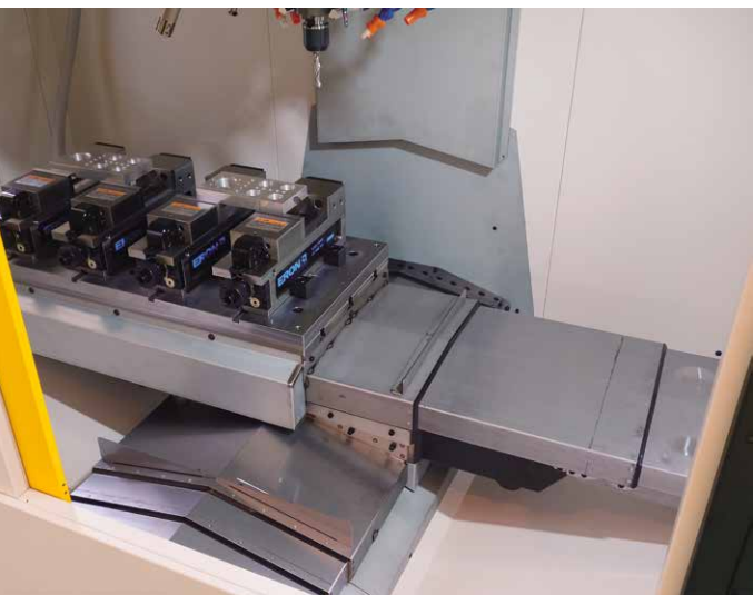
机床内部盖板
