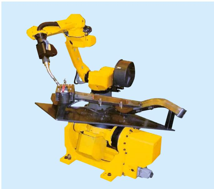
使用伺服焊炬进行汽车零件的弧焊
