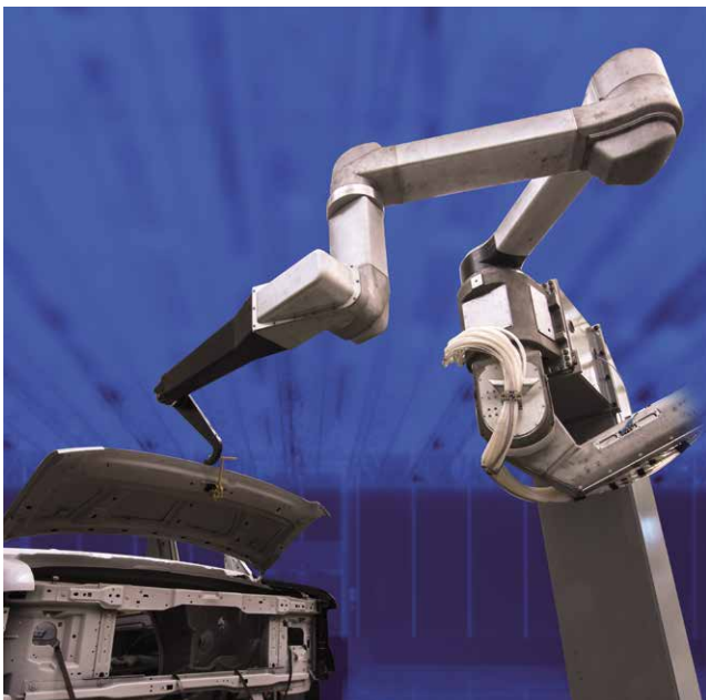
开启汽车前盖板用P-35 i A
