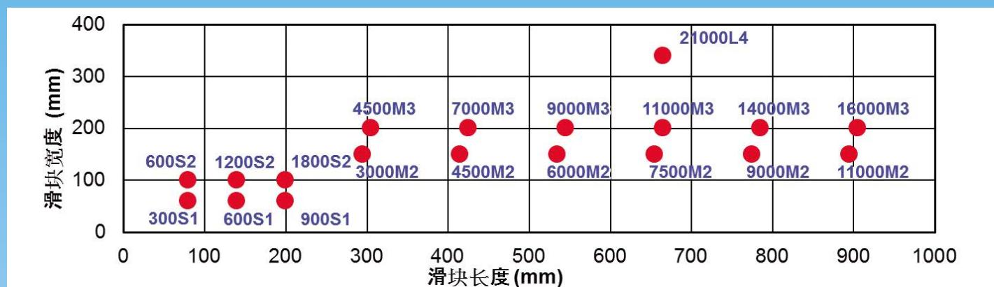
FANUC LINEAR MOTOR *Lis-B* series 由包含了最大推力 300N 至 21000N 的 19 个型号构成，全部型号都可以实现 400V 电压驱动。
