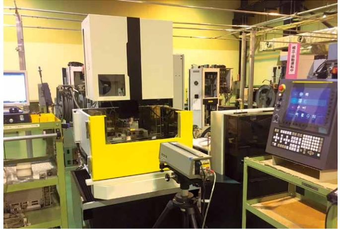
机床精度自动测量系统（激光长度测量）
