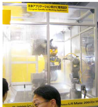
通过大小2台清洗机器人进行高压清洗的演示
