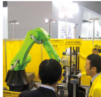
可搬运质量为35kg的协同作业机器人进行组装作业的演示
