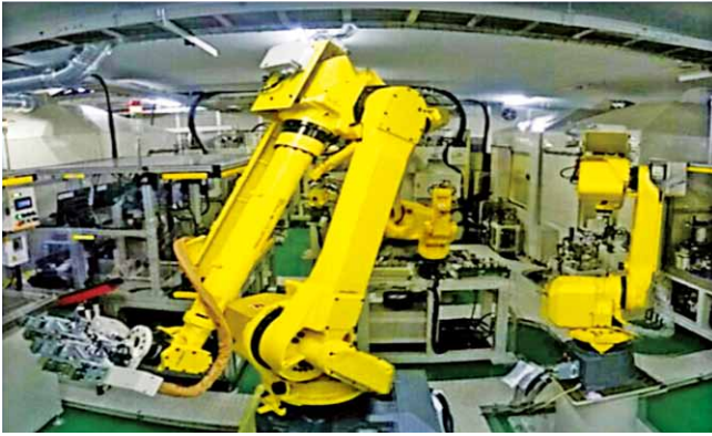
悬架焊接生产线中引进发那科机器人（福岛事业所）
