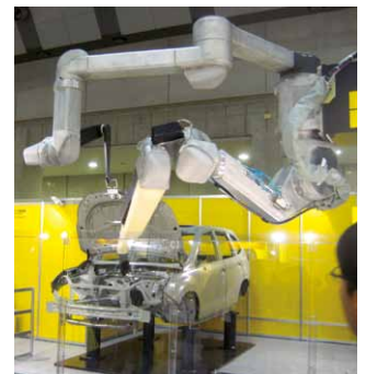
7轴喷涂机器人和打开盖板用机器人一体化的紧凑设计赢得了好评
