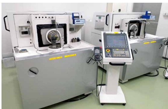
使用 ROBONANO \alpha -0iB 对反射镜支架进行加工（1楼）
