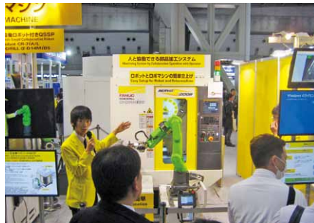
通过使用绿色机器人的 QSSP 功能，即使是对机器人操作不熟悉的用户也能轻松连接 ROBOMACHINE
