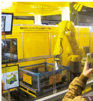
首次展出可安装在机械手上的新3D视觉传感器
