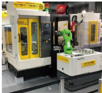
通过ROBOTDRILL的QSSR和AGV机器人供应零部件
