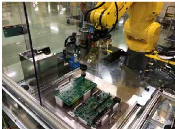
利用机器人模块紧固PCB螺丝
