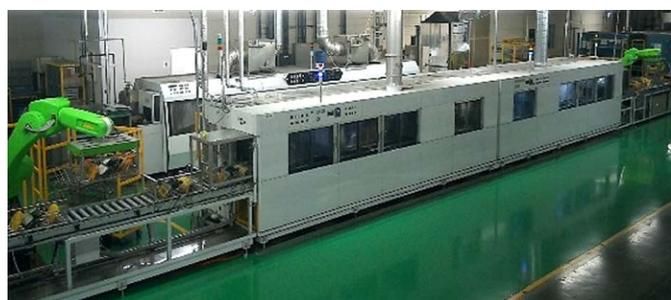
进行修理品投入与回收的2台协同作业机器人和自动清洗机
