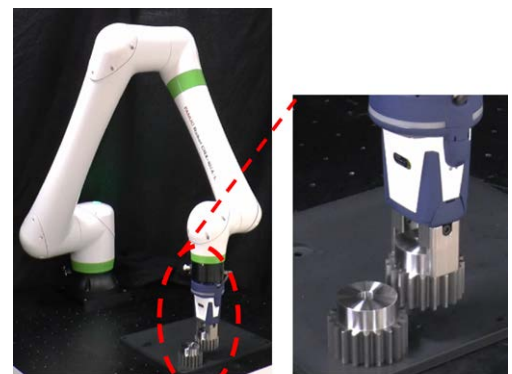
使用力觉控制功能插入齿轮
