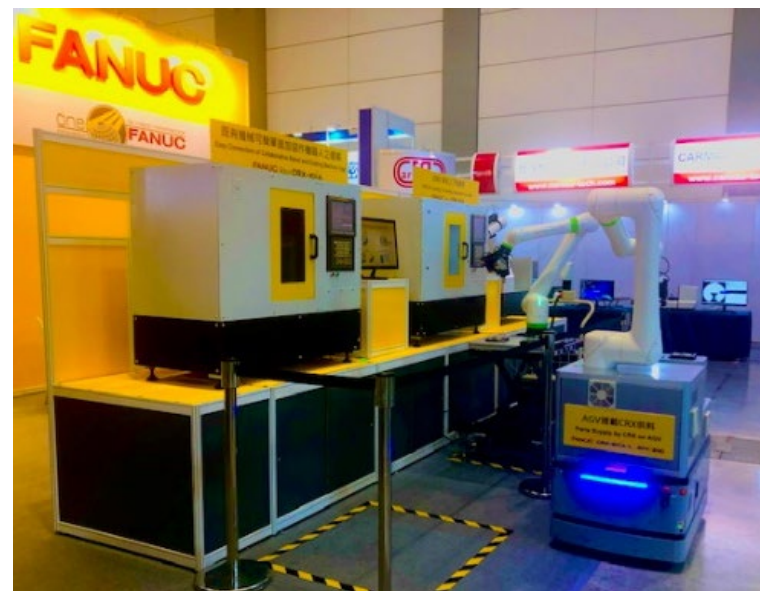
AGV、台車に載せたCRXによる ロード・アンロードシステム
