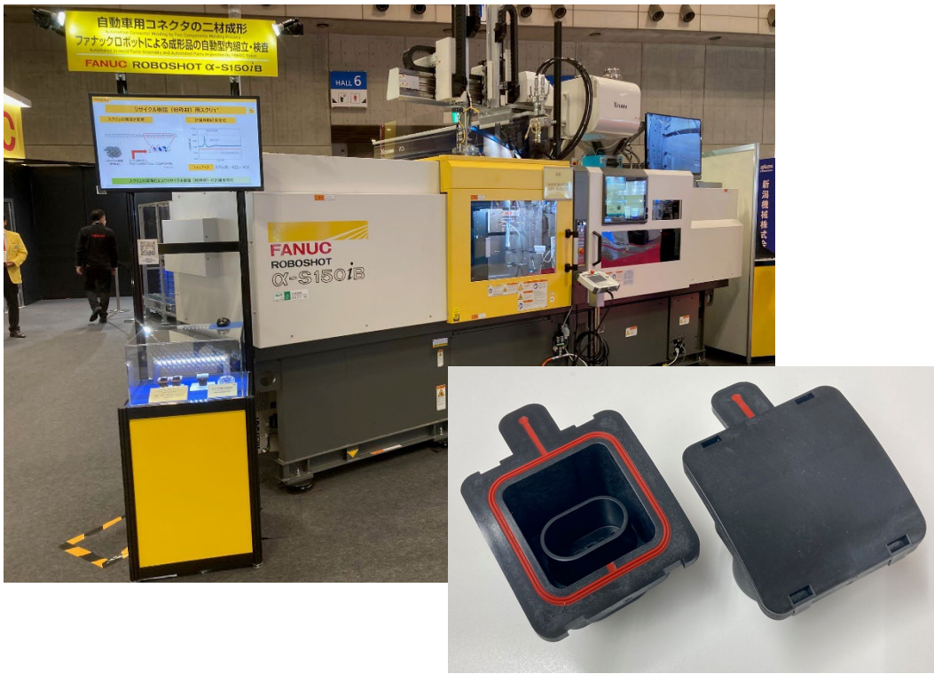
自動車用防水コネクターの二材成形
