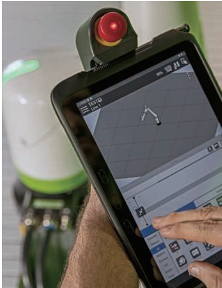
タブレットTPでアイコン によるロボットのプログラ ミングが可能
