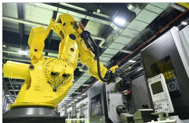
大ロボットを使用した大型部品加工セル
