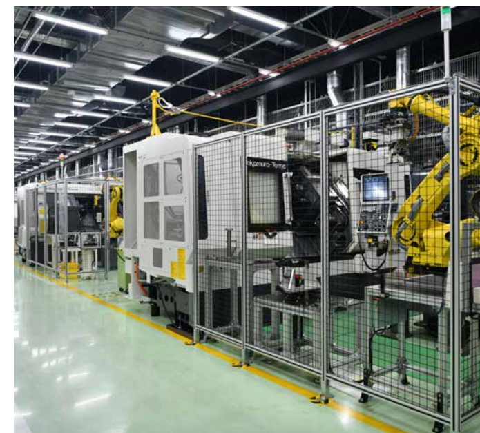
自動倉庫に接続された加工セル群
