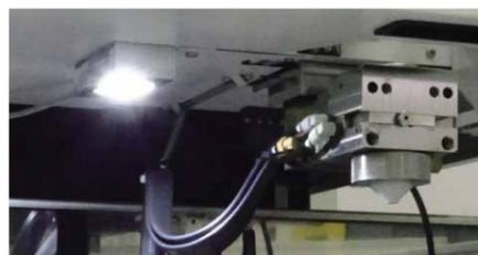
加工槽内用照明灯(高輝度LED)
