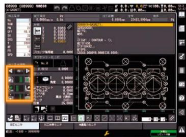
画面のキー操作で加工条件を調整
