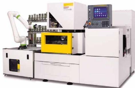
ロボットによるワーク交換システム例
