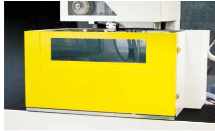
加工槽正面自動昇降ドア
