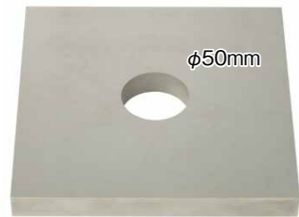
SKD11材20mm厚 φ0.25 黄銅線 6回加工 φ50mm 真円度 0.90μm
