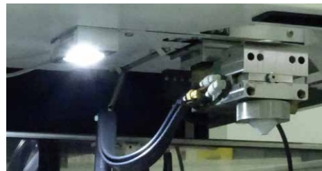
加工槽内用照明灯(左側)
