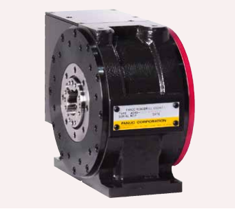
DDRiB ダイレクトドライブモータによりバックラシレスの高速・高精度位置決め可能な専用付加1軸回転テーブル。最高回転数300min -1
