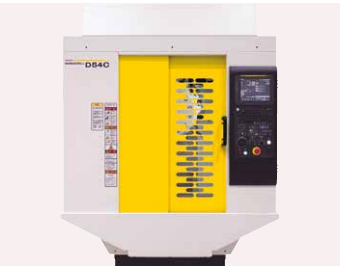
前面2枚扉仕様 大型ワークや治具の交換が容易になります。開口幅:730 mm(D54C) / 1095 mm(D74C) *D116Cでは指定できません。
