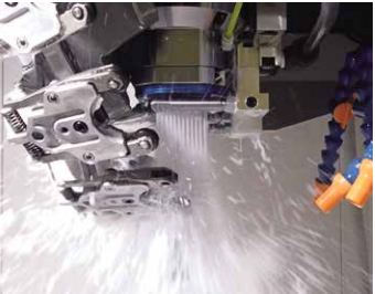
テーバ洗浄機能 工具交換動作中に工具および主軸テーバ部をクーラントで洗浄し、切粉の噛み込みを低減します。
