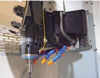
クーラント装置(ノズル部) 4本のノズルにより、異なる長さの工具に対しても加工点に確実にクーラントを供給します。主軸内部に配管を通して機内干渉を低減しました
