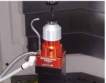
工具長スイッチ オートラベル検出信号を備えた高信頼性タイプを採用。多機能な測定マクロプログラムも標準搭載しています。
