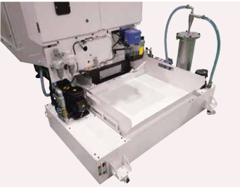
クーラント装置(タンク部) センタースルーポンユニットも搭載可能な260Lタイプ(写真)と、コンパクトな120Lタイプが選択可能です。
