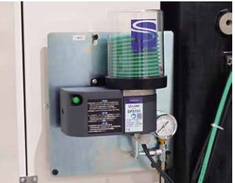
グリス自動潤滑 XYZ軸のガイドとボールねじへのオイル自動潤滑(標準)を、消費量が少なくランニングコストに優れるグリスタイプに変更します。
