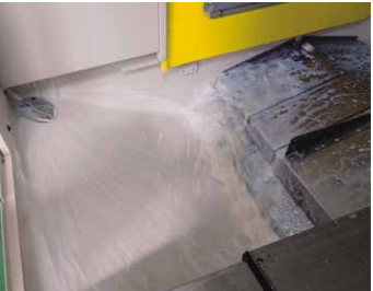
機内洗浄機能 加工中に機内に飛散する切粉を洗い流します。新形状配管により洗浄効率が大幅に向上しました。
