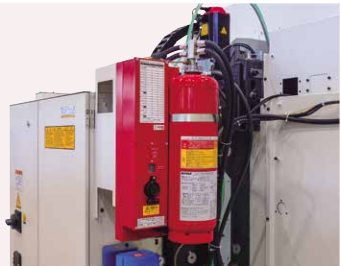
自動消火装置 可燃性材料を加工する場合や不水溶性クーラントを使用する場合に使用します。
