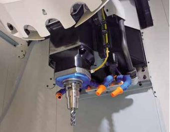
クーラント装置(ノズル部) 4本のノズルにより、異なる長さの工具に対しても加工点に確実にクーラントを供給します。主軸内部に配管を通すことで機内干渉を低減しました
