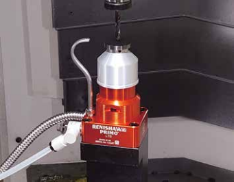
工具長スイッチ オーバトラベル検出信号を備えた高信頼性タイプを採用。多機能な測定マクロプログラムも標準搭載しています。
