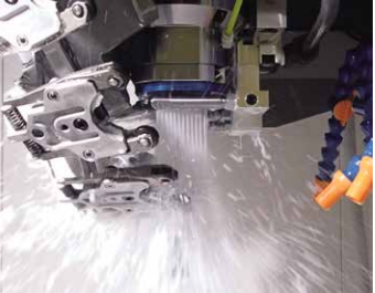
テーパ洗浄機能 工具交換動作中に工具および主軸テーパ部をクーラントで洗浄し、切粉の噛み込みを低減します。
