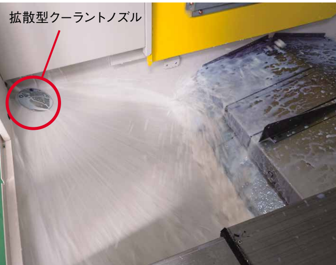
機内洗浄の様子
