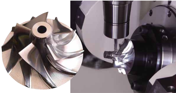
DDモータ仕様2軸テーブルを使用した インペラの高速加工
