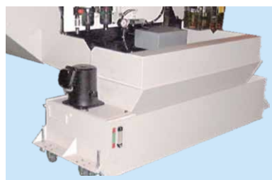
クーラント装置 (タンク部)
