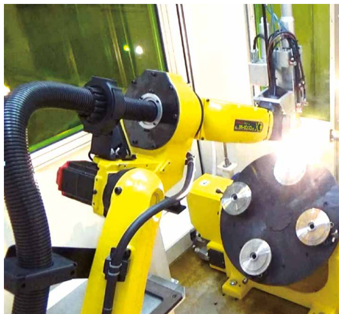
ファイバレーザ溶接
