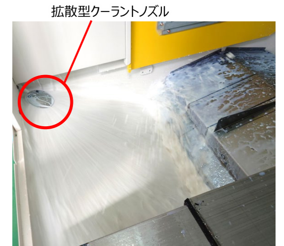
機内洗浄の様子
