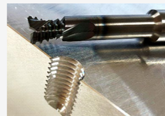
スレッドミルによる穴あけとねじ切りの同時加工
