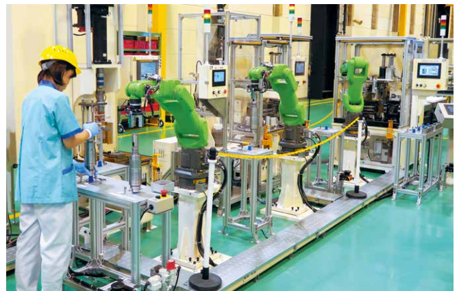
主軸の組立て Assembly of spindles
