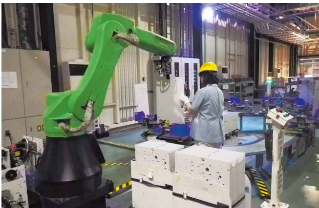
作業者と協働ロボットによるユニット組立て Assembly of a unit by a worker and collaborative robot
