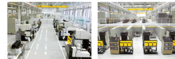
信頼性評価棟の大部分を占めるこのエリアでは、信頼性の徹底検証のために加速寿命試験を行っています。ばらつきを考慮してサンプル数を増やし、様々な条件で加速寿命試験を実施することで商品の長期信頼性を評価します。
