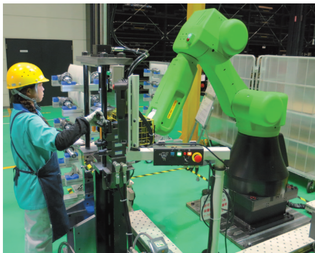
ロボショット組立工場における 協働ロボットと人の協働作業による高効率組立システム
