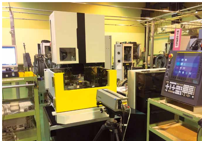
機械精度の自動測定システム（レーザー測長）
