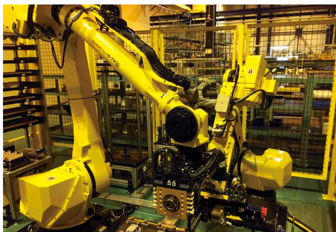
多品種生産を行う自動組立システム (加工液排水ユニット、加工槽シールユニットほか)
