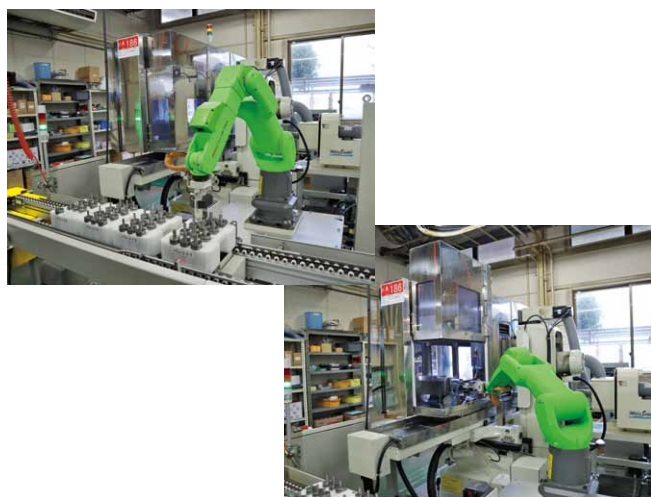
協働ロボット CR-7iA を用いた円筒研削自動化システム
