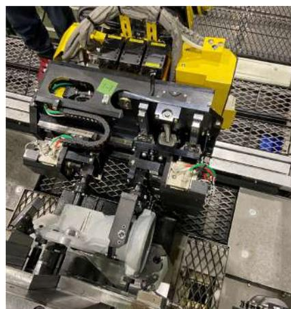
加工治具へのワークの着脱
