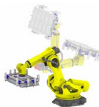
電気自動車用バッテリーユニットの搬送
