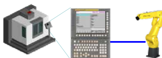
CNCとロボットをイーサネットケーブル1本で接続
