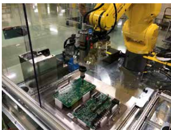
ロボットモジュールによるPCBねじ締め
