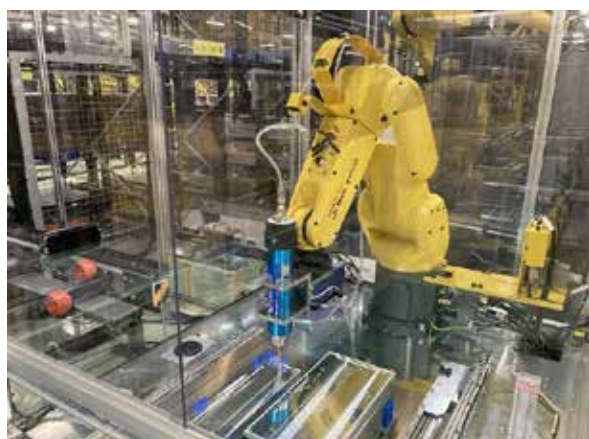
ロボットモジュールによるシール剤塗布
