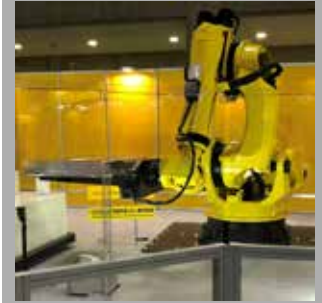
新機種の1t可搬ロボットの 高可搬ながらコンパクトな デザインが好評
