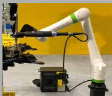
新機種CRX-20iA/Lの高可搬ながら軽量アームに注目
