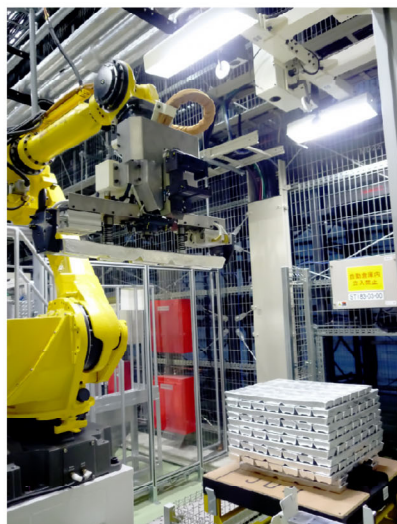
バラ積みセンサでインゴットを検出し取り出す
