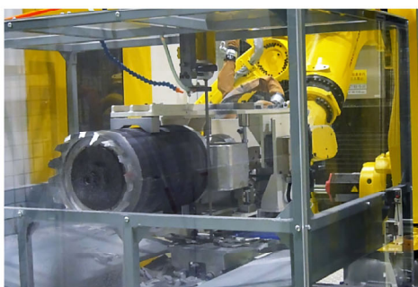
鋳造済ワークの湯口を汎用バンドソーで切断
