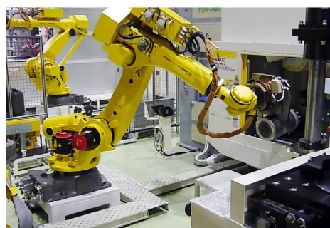
ROBODRILLで湯口切断部を加工
