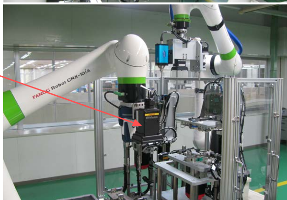
協働ロボット CRX-10iA を導入した小型βiパルスコーダ信号調整システム
