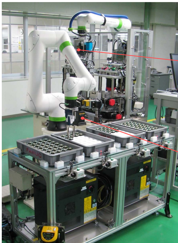
協働ロボット CRX-10iA を導入した小型βiパルスコーダ信号調整システム
