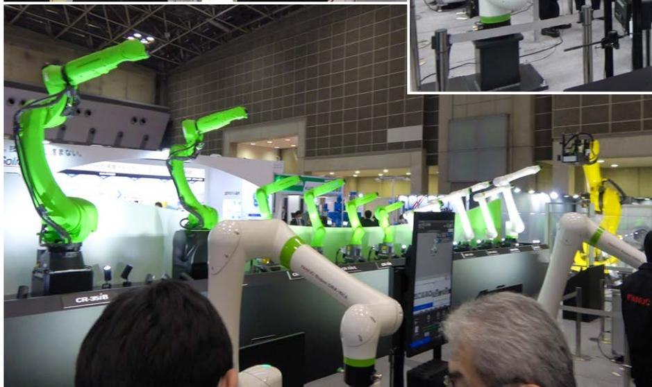
ロボットコーナーでは、安全柵なしで人と一緒に働ける協働ロボットの幅広いラインナップを紹介し、特に30kgも運べて、さらに人の手で簡単に動かせるCRX-25iAの体験展示に注目が集まりました。また、協働ロボットが工作機械にワークを着脱する展示では、お客様が今お使いの工作機械にロボットを簡単に後付けできる点が好評でした。
