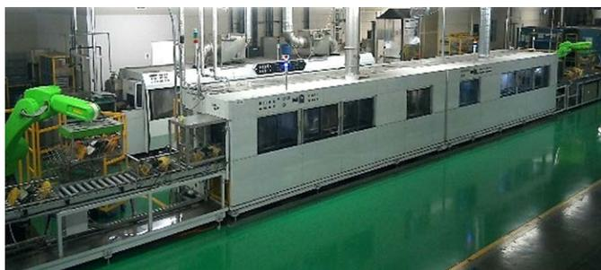
修理品の投入と回収を行う2台の協働ロボットと自動洗浄機
