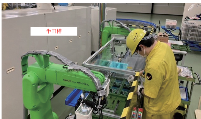
プリント板半田付けライン (協働ロボット2台)
