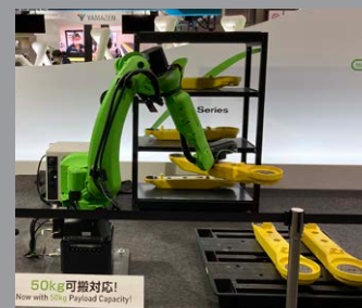
50kg可搬対応の協働ロボットによる鋳物搬送
