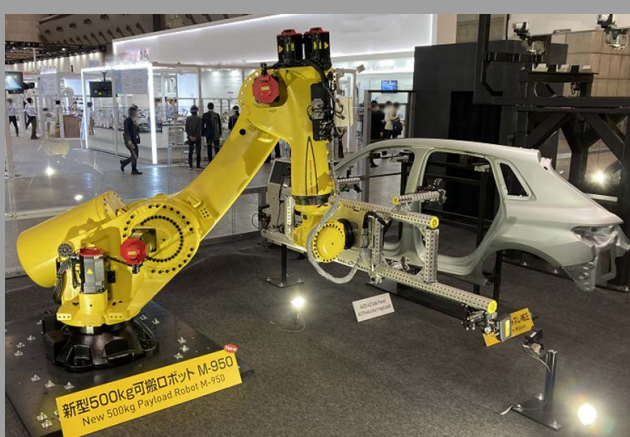
500kg可搬ロボットによる車体パネル搬送
