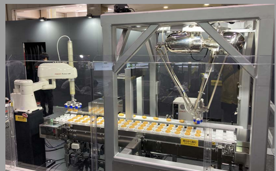
食品対応ロボットによる高速搬送
