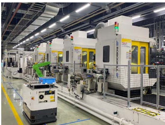
RocoMo-Vによる素材供給・製品回収
