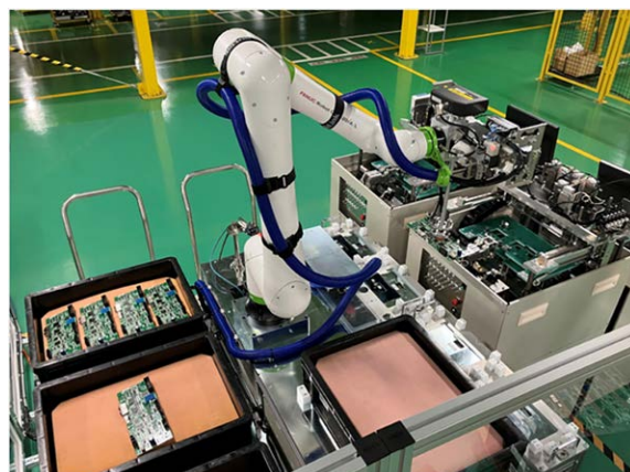
\alpha i-Dシリーズ 自動試験設備 (CRX-20iA/L 使用) (写真3)
