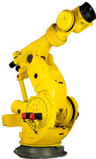
最大 2.3 t 可搬の大型 6 自由度多関節ロボット M-2000iA
